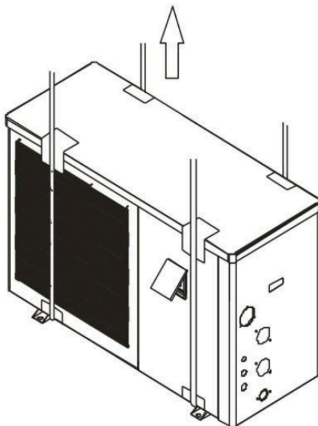
Guia para levantamento da bomba
