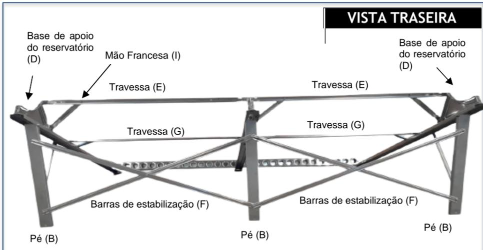
Fazer a união da Travessa (E) na base de apoio do reservatório (D) fixar e parafusar as barras de estabilização (F) em X até a furação do Pé (B) fixar e parafusar a Travessa (G) na Barra de apoio do reservatório (A). Travar e fixar a Mão Francesa (I) entre a Travessa (E) e as Barras de apoio do Reservatório (A)
