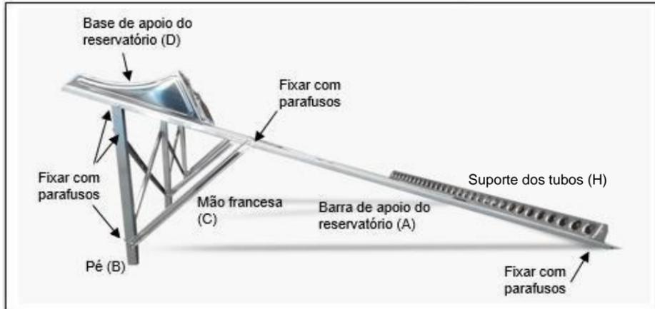
Fazer a união da Barra de apoio do reservatório (A) com o Pé (B) fixando os parafusos, e fixar Mão francesa (C) entre Barra de apoio do reservatório (A) e o Pé (B) fixando os parafusos em cada, conforme a imagem.
