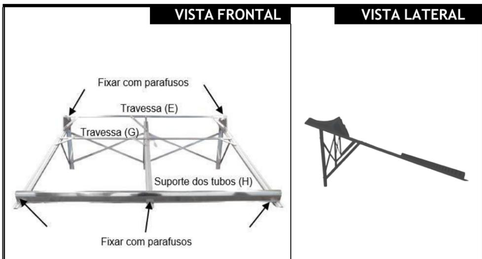
Fixar o Suporte dos tubos (H) na base do suporte montado, completando assim a montagem deste.
