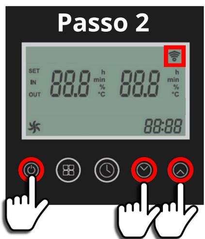
No painel da bomba pressione o botão **POWER** (power symbol), o botão **AJUSTE PARA CIMA** (up arrow) e **AJUSTE PARA BAIXO** (down arrow) juntos por 5 segundos, o símbolo de Wi-Fi irá começar a piscar.
