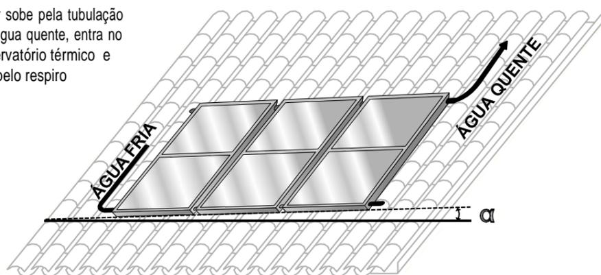
Ao instalar os coletores, é necessário colocar uma inclinação de mais ou menos cinco graus como mostrado no esquema ao lado. A incorreta aplicação da inclinação, implicará no mau funcionamento dos coletores e distribuição da água quente.
