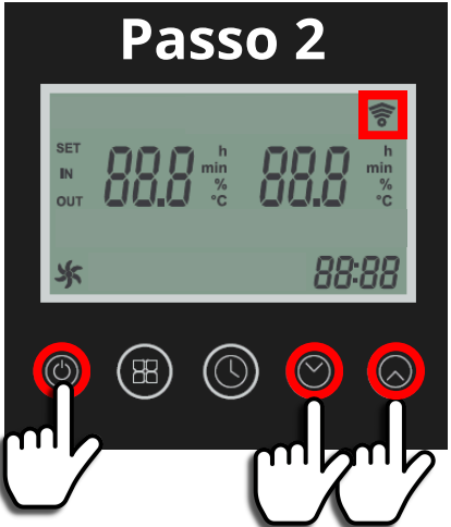
No painel da bomba pressione o botão POWER (🔌), o botão AJUSTE PARA CIMA (⬆️) e AJUSTE PARA BAIXO (⬇️) juntos por 5 segundos, o símbolo de Wi-Fi irá começar a piscar.
