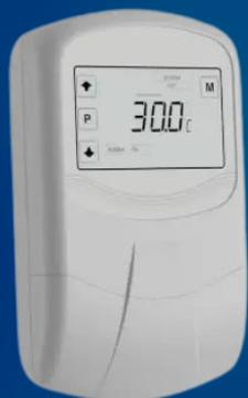
Os CDT's da KS tem um sistema de proteção interna que liga a bomba caso a água dos coletores atinja temperaturas muito baixas, como 5°C, é importante que esta temperatura nunca esteja muito próxima do limite de congelamento, pois a água pode estar em diferentes temperaturas em diferentes pontos do coletor, e o sensor de temperatura sempre estará localizado no ponto mais alto da mesma. OBS.: Sempre deverá estar ligado a energia elétrica.
