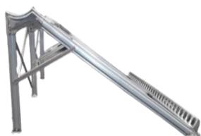
Fixar o Suporte dos tubos (H) na base do suporte montado, completando assim a montagem deste.
